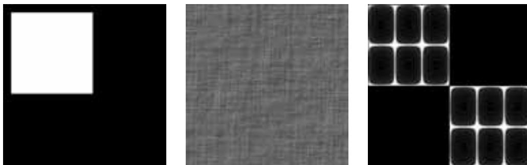
図10 入力画像である振動板の強度分布(左)とそのフーリエ変換型デジタルホログラム(中)および時間平均法の再生像(右).
