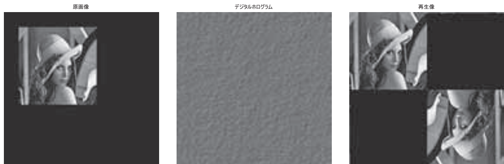
図8 入力画像(左)とそのフーリエ変換型デジタルホログラム(中)および再生像(右)。
