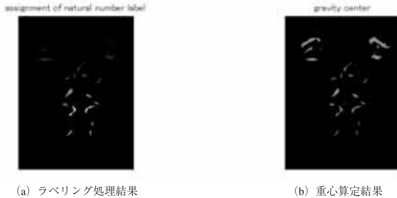
図-4 ラベリング処理, 重心算定結果
