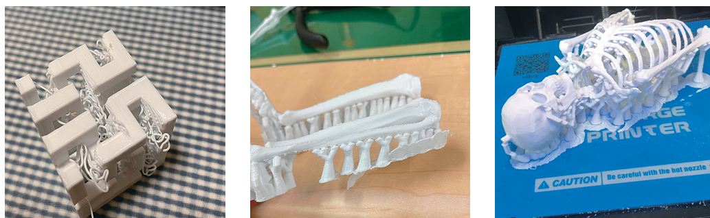
図3 出力失敗例(左)、サポート材(中)、骨格の上半身出力結果(右)
