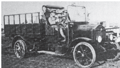
(東京瓦斯電気) ウーズレー CP 型軍用トラック (大正 13 年軍用自動車補助法の資格試験に合格)
