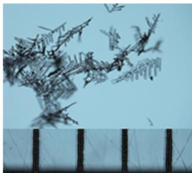
図3 人工雪粒子（目盛単位：1 mm）
