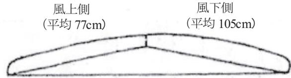
図20 dライン積雪断面形状
