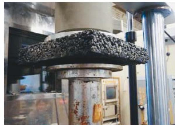
写真 3.2 載荷試験の状況
