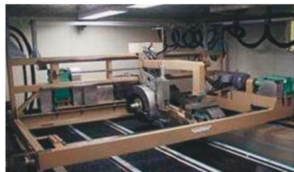
写真 4.1 室内凍結路面走行試験装置
