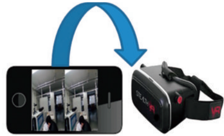
図 8 立体視用左右画像をスマートフォンで表示し VR ヘッドセットに装着して立体視を確認
