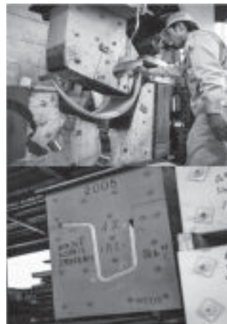
図表4 曲線美を持った家具の一例(写真の椅子は『ORIZURU』)とプレス機での成形の様子 出所:左の写真は筆者撮影。右の写真は天童木工より許可を得て当社のホームページから転載。
