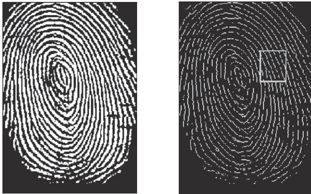
図2 原画像（左）とその細線化画像（右）．細線化画像中の白い枠はひとつの解析領域．原画像サイズ364×256．解析領域サイズ60×50．
