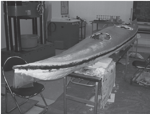
写真-13 エポキシ塗布完了時
