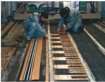
写真-4 凍結路面の作製状況
