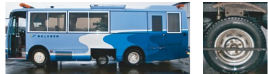
写真-11 バス型すべり試験車 (LWFT)
